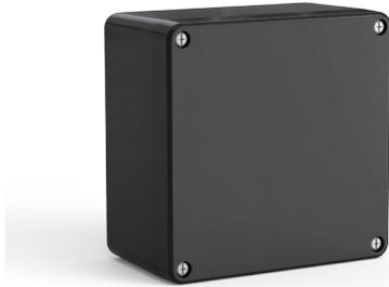
**Descripción:** Caja de bornas de poliéster para aplicaciones que exijan seguridad aumentada Ex e. Poliéster reforzado con fibra de vidrio moldeado por compresión y con agentes añadidos para evitar la acumulación de carga estática. Insertos internos M4 o M6 de acero inoxidable para montaje en panel y carril DIN. Las dimensiones de las posiciones de montaje están moldeadas en la parte posterior del armario. Se facilitan tornillos cubiertos fuera de la zona con juntas.
