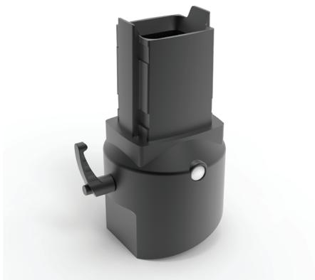
**Zusätzliche Informationen:** Verwenden Sie die nach vorn geneigte Winkelkupplung, um das Gehäuse in einem 15-Grad-Winkel nach vorn geneigt zu montieren. Das Gehäuse kann um 300 Grad gedreht und arretiert werden. Mit Sicherheitsanschlag und wartungsfreiem Lager. Schwarze Oberfläche, RAL 9005. Aluminiumdruckgusskonstruktion. Mit Installationsanleitungen, Dichtungen, Rohrbefestigungsschrauben und Befestigungsteilen für das Gehäuse.
