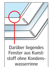
Darüber liegendes Fenster aus Kunststoff ohne Kondenswasserinne
