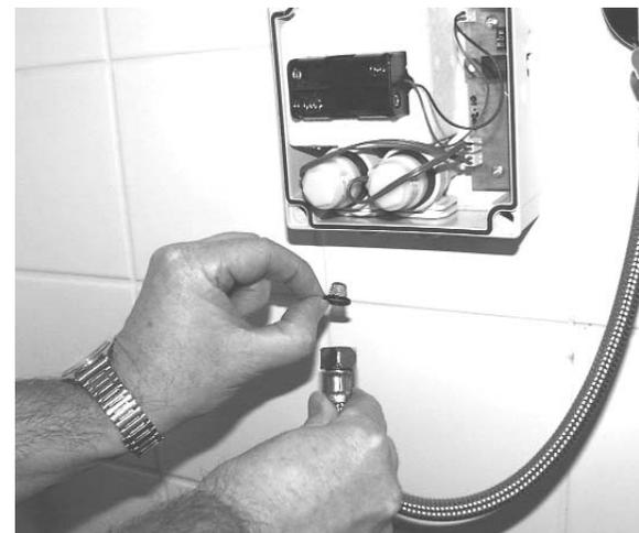
Der Batteriehalter herausziehen und die beigefügten 4 Batterien LR6, AA 1,5V montieren.
