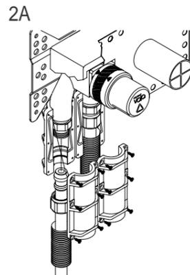
1/2" Anschluss für Rohr-in Rohr Montage
