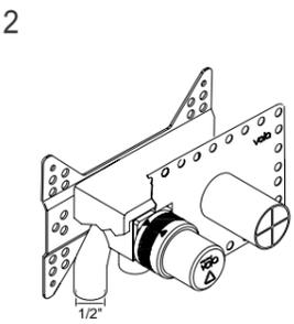
1/2" Anschluss an Eisen-, Kupfer-, Stahl- oder Kunststoffrohr
